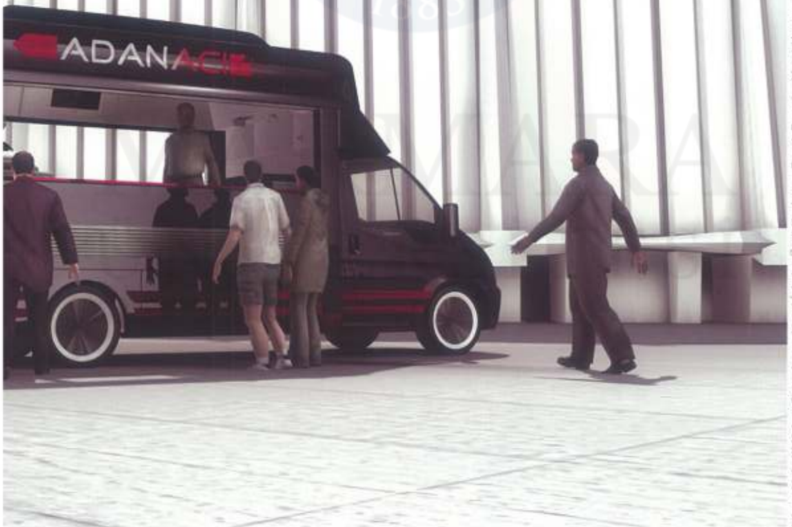
Adana Mahallî Kebab Satış Aracı, Metal İskelet Üstü Kaplama, Esnek Branda - Metal, Uçyay = 6m x 2,20m x 3m Mobile Adana Kebab Truck, Stretch Branda - Metal, Uçyay = 6m x 2,20m x 3m
