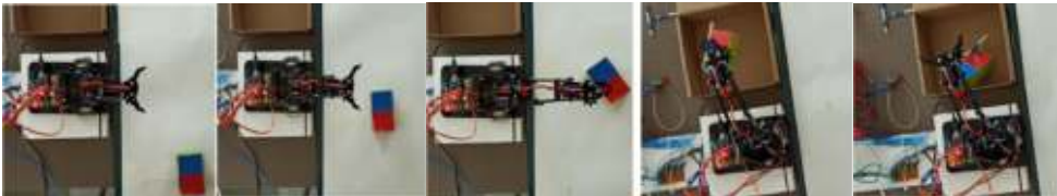
Şekil 4. Robot kolun nesneyi yakalaması evreleri
